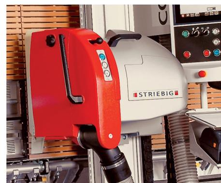
*Verbesserte Standard-Ausstattung für Striebig 4 D und Control: ASP, die automatische Sägebalken-Positionierung. Das manuelle Verschieben des Sägebalkens entfällt, der Bedienerkomfort steigt. Fotos: Striebig AG*
